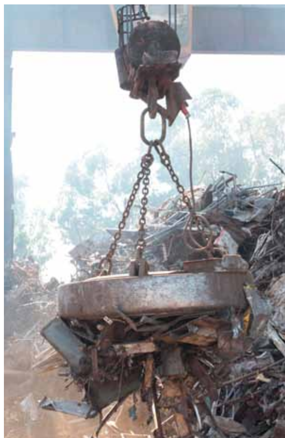
Figuur 6: 'n Elektromagneet word gebruik om metale in 'n skrootwerf te sorteer.
